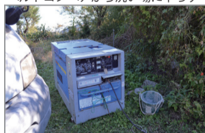
ベルトコンベアは発電機で動かしている
